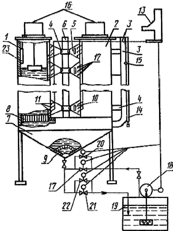
1.2. Гидравлическая часть установки содержит две измерительные трубы 1 и 2 и указательную трубку 3, которые соединены между собой через равные интервалы по высоте полыми трубками 4. Трубы 4 снабжены конусообразными переходными секциями 5, ориентированными своими основаниями в сторону измерительных труб 1 и 2.
